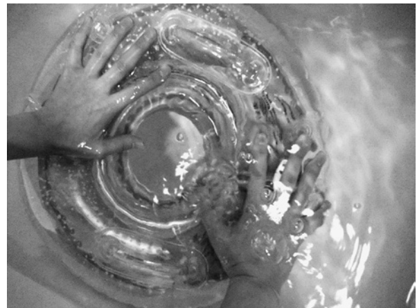
写真3 下面を上にして浮き輪を沈めると、僅かに空気の漏れが認められる。
